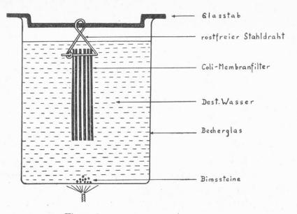
Figur 1 Aufhängevorrichtung der Membranfilter zur Sterilisation
