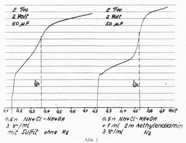
Links: Ohne Zusatz von Äthylendiamin erhaltene Kupferstufe Rechts: Unter Zusatz von Äthylendiamin erhaltene Kupferstufe
