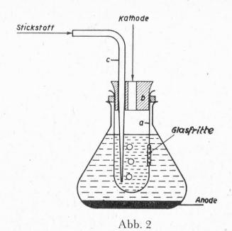
Elektrolysiergefäss für die polarographische Kupferbestimmung
