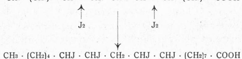
Zur Bestimmung dieser Doppelbindungen, d.h. des Sättigungsgrades einer Verbindung, wird die zu untersuchende Substanz in einem indifferenten Lösungsmittel gelöst und mit einem Überschuss an Halogenlösung reagieren gelassen. Nach einer gewissen Einwirkungszeit wird das unverbrauchte Halogen bestimmt. Die dem angelagerten Halogen äquivalente Menge Jod in Prozenten wird als Jodzahl bezeichnet.
