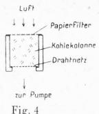
Filterelement für Luftproben
