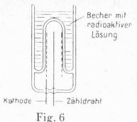
Fig. 6 Becher-Zählrohr
