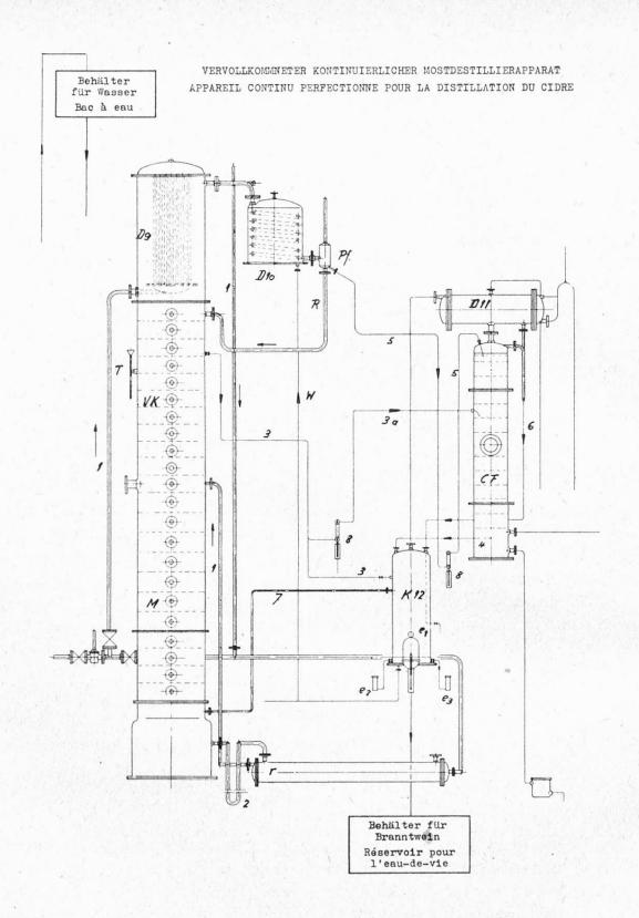
Kondensatoren werden diese Vorlaufprodukte weiterkonzentriert und teilweise in sehr konzentriertem Zustande besonders abgesondert (Röhre 6 und Kühler K 12, welcher den Kühler für den Vorlauf enthält). Der Apparat ist so konstruiert, dass es möglich ist, Branntweine und Vorläufe gleichzeitig, wenn es angezeigt ist, sowohl aus der Verstärkungs- wie aus der Schlusskolonne zu entnehmen.
