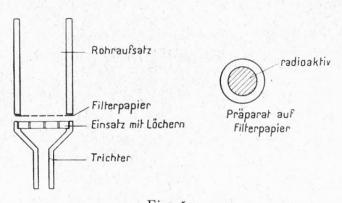
Fig. 5 Filtriervorrichtung aus Plexiglas
