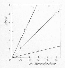
Das Instrument misst den Druckabfall längs einer Kapillare mit eingesetztem konischem Glasstab, wobei der Druckabfall der Stromstärke direkt proportional ist. Die Beziehung zwischen diesen Grössen wird für Luft und Sauerstoff separat durch Eichung festgelegt. Abb. 5 zeigt eine solche Eichkurve für Luft. Eine ausführliche Beschreibung des Anemometers erfolgt an anderer Stelle (Wenger [1954]).
