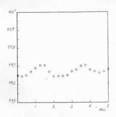
durch ein Kontakthermometer (Bereich 80–120°, Einteilung in ½ Grade, Hediger AG, Basel) über ein elektronisch gesteuertes Relais (Typ Sch. 3617, Gfeller AG, Bern-Bümpliz). Bei einer Betriebstemperatur von 100° schwankt die Temperatur des Ölbades um ca. 0,08° (Abb. 7).
