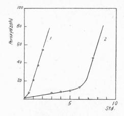
Abb. 2 Wirkung von Antioxydantien Stabilitätstest AOM bei 1150
