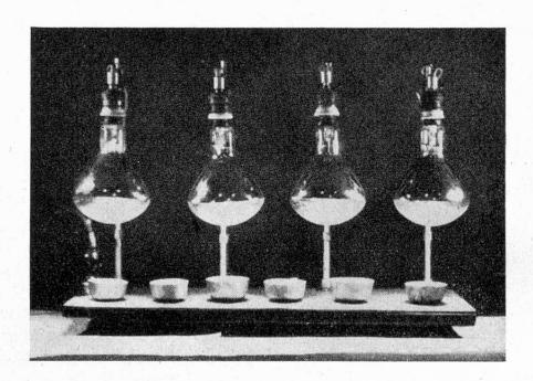
allzu starke Erhitzung zu vermeiden, ist die vorherige Bestimmung der optimalen Entfernung zweckmässig; eine Überhitzung kann bei Speiseeisgemischen zur Karamelisierung führen, was zu unrichtigen Werten für den Trockengehalt führt. Bei den von uns durchgeführten Versuchen (vgl. Tabelle) ergab sich bei Verwendung von Lampen zu 250 Watt eine optimale Entfernung von 15—18 cm, vom Rande des Metallüberzuges an gemessen.
