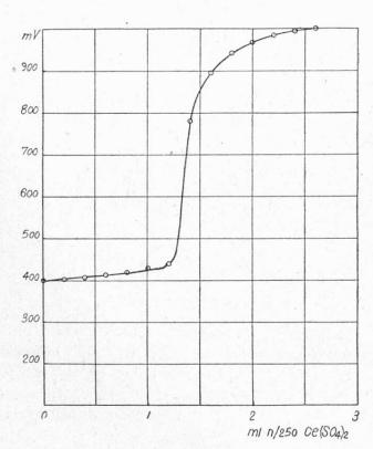
Mit Ausnahme der beiden schwefelhaltigen AO Tetraäthylthiuramdisulfid und Thiodiproprionsäure werden alle Stoffe oxydiert und liefern saubere Titrationskurven. Wie beim Guajakharz aus der Kurvenform zu schliessen ist, liegen darin mehrere oxydierbare Komponenten vor.
