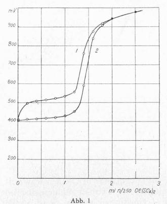
(1) Titration von 0,49 mg 3-t-Butylhydroxyanisol
