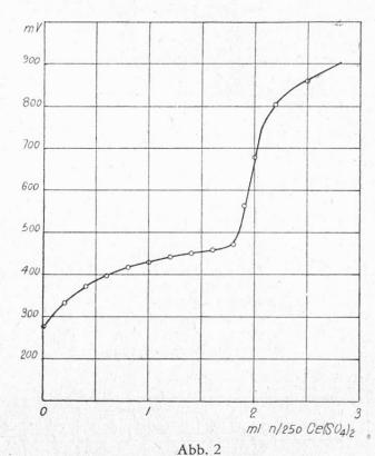
Titration von 0,5 mg Nordihydroguajaretsäure Mittelwert des Potentialsprungs: 1,95
