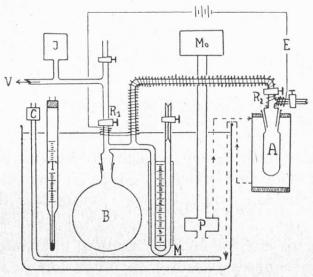
Figure 1 Appareil pour la mesure des pressions de vapeur d'eau
