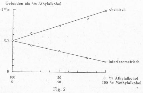
Destillation von Gemischen von Methylalkohol mit Äthylalkohol. Gesamtalkoholgehalt entsprechend 0,5 ‰. Analysenwerte ausgerechnet, wie wenn es sich um reinen Äthylalkohol gehandelt hätte. Obere Kurve: Titrationsergebnis. Untere Kurve: interferometrischer Wert. Die bei den chemischen Werten etwas grössere Streuung rührt teilweise davon her, dass Methylalkohol sich schlechter titrieren lässt als Äthylalkohol.
