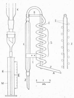
Fig. 1 Kühlersystem und Vorlage für die Alkoholdestillation
