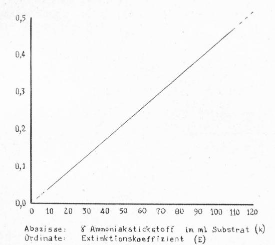
Eichkurve für colorimetrische Bestimmung des Ammoniakstickstoffes mit Hilfe des Photometers «Lumetron» Mod. 402 EF
