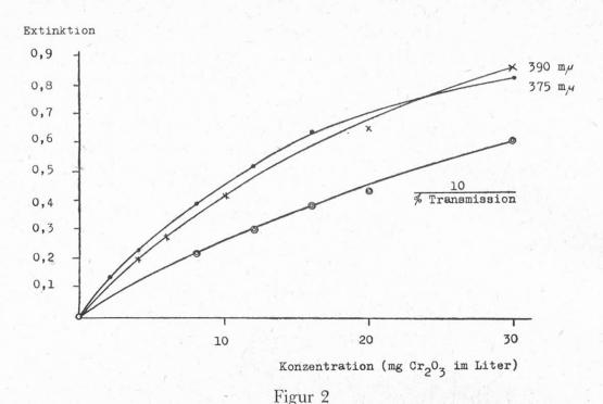
Beziehungen zwischen Extinktion bzw. dem reziproken Wert der Lichttransmission und der als Chromoxyd ausgedrückten Chromkonzentration
