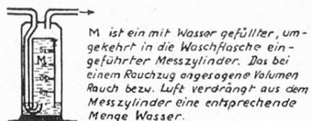
Um den natürlichen, intermittierenden Rauchvorgang möglichst getreu nachzuahmen, erfolgt alle 15 Sekunden ein Zug. Für die Absorption des Nikotins genügen zwei Waschflaschen mit Glasfilterboden. Versuche haben gezeigt, dass in einer dritten Waschflasche weniger als 0,1 mg Nikotin absorbiert wird. Diese Menge fällt praktisch nicht ins Gewicht.
