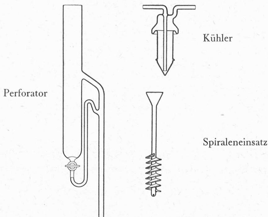
Wie aus der obenstehenden Skizze ersichtlich ist, besteht der eigentliche Perforator selbst aus einem Stück und kann mit einem Schliffkölbchen und einem Einhängekühler zur endgültigen Apparatur ergänzt werden. Für die Ätherperforation kommt noch ein besonderer Einsatz dazu. Je nach der Stellung des Zweiweghahns kann die Perforation bald mit Äther, bald mit Chloroform vorgenommen werden. Die Grösse des Apparates ist so bemessen, dass bequem 100 cm<sup>3</sup> Flüssigkeit extrahiert werden können.
