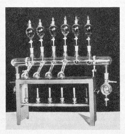
Bild 1 Apparatur zur Bestimmung von Spurenmetallen
