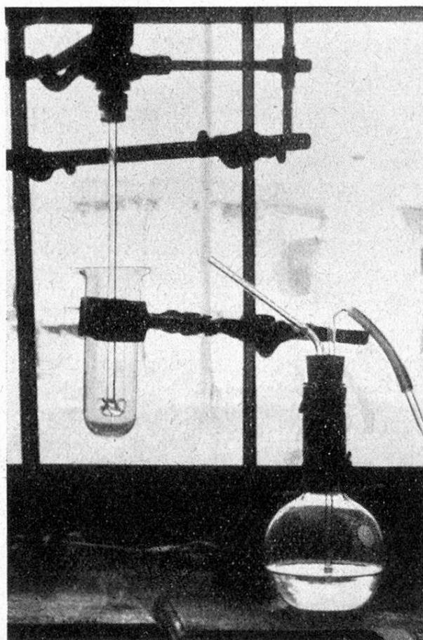
verre épais, pour supporter la centrifugation, pourvue en outre d'un bec pour faciliter la décantation et enfin assez large pour qu'un agitateur en forme d'hélice puisse y tourner (assez rapidement pour assurer une bonne agitation et pas trop vite pour éviter les projections). Voici, par exemple, les dimensions de l'éprouvette que j'ai utilisée: diamètre intérieur 3,5 cm, longueur 11 cm, ce qui correspond à une contenance d'environ 100 cm<sup>3</sup> (voir figure).
