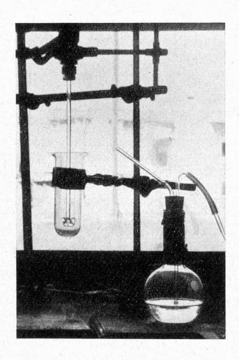
verre épais, pour supporter la centrifugation, pourvue en outre d'un bec pour faciliter la décantation et enfin assez large pour qu'un agitateur en forme d'hélice puisse y tourner (assez rapidement pour assurer une bonne agitation et pas trop vite pour éviter les projections). Voici, par exemple, les dimensions de l'éprouvette que j'ai utilisée: diamètre intérieur 3,5 cm, longueur 11 cm, ce qui correspond à une contenance d'environ 100 cm³ (voir figure).
