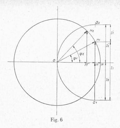
rayon lumineux traversant la préparation. Si cette dernière agit seulement comme préparation d'amplitude, le vecteur prendra les longueurs  $\overline{OM}$ ,  $\overline{OM}$ . Une variation de phase  $\varphi$  provoque une rotation  $\varphi$  autour du centre O, et l'extrémité M vient en  $M_1, M_2 \dots$  etc.
