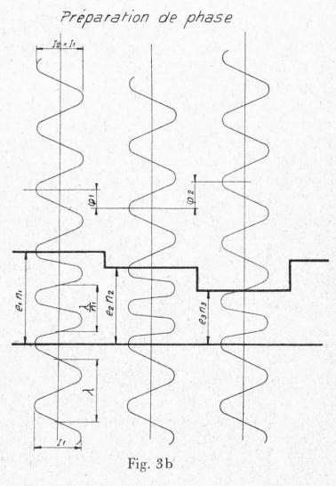
Le chemin optique d'un rayon lumineux, est égal produit du chemin géométrique multiplié par l'indice de réfraction des couches traversées. C'est le principe de Fermat qui est à la base du calcul des combinaisons optiques. Une préparation microscopique est un milieu dans lequel l'épaisseur et l'indice de réfraction varient. Elle peut donc être schématisée selon la figure 3 b. A condition que l'on ait:
