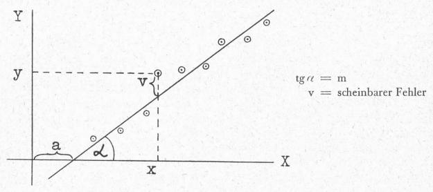
volumen ergänzt zur Reaktion. Die dabei verwendete Anzahl Volumeneinheiten der Stammlösung wird auf der X-Achse als Abszisse x aufgetragen. Die dazugehörige Ordinate y ist der gemessene Umsetzungswert.
