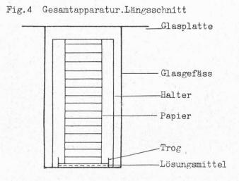
Das eine Ende des Papierstreifens wird in den Trog mit der wasserhaltigen beweglichen Phase getaucht und diese steigt nun infolge Kapillarität mit scharfer Frontlinie nach aufwärts.
