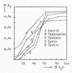
Die R<sub>f</sub>-Werte werden praktisch nicht beeinflusst durch die Anwesenheit ähnlicher Verbindungen, bei vergleichbaren Konzentrationen. Man kann z. B. gleichzeitig 20 verschiedene Aminosäuren auf einem Papierchromatogramm trennen. Dent <sup>26</sup>) gibt einen genauen Lageplan für über 60 α-Aminosäuren, wobei eine leichte Ablesung der R<sub>f</sub>-Werte möglich ist.
