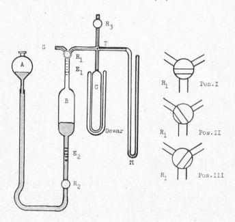
de 60 cm³ environ, a une forme allongée et doit être fait avec un verre résistant à de grands écarts de température. Un récipient de Dewar, de forme et de grandeur appropriées au condenseur, complète l'appareillage (le niveàu de l'air liquide doit dépasser de quelques millimètres le sommet du condenseur).
