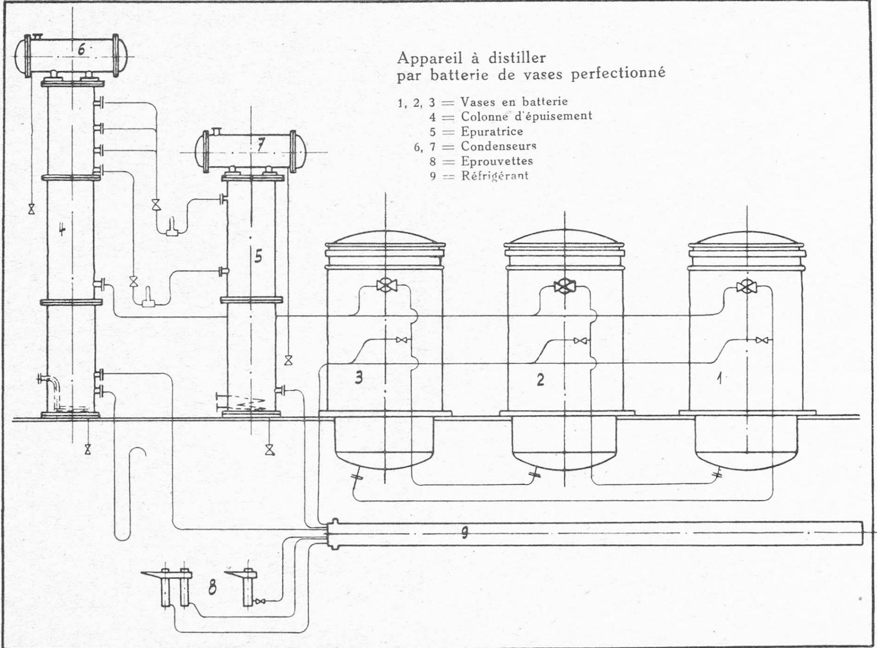
L'appareil est construit de manière qu'on puisse l'utiliser pour la production d'eaux-de-vie qui n'exigent pas la séparation de fortes quantités d'impuretés alcooliques, surtout d'alcool méthylique.
