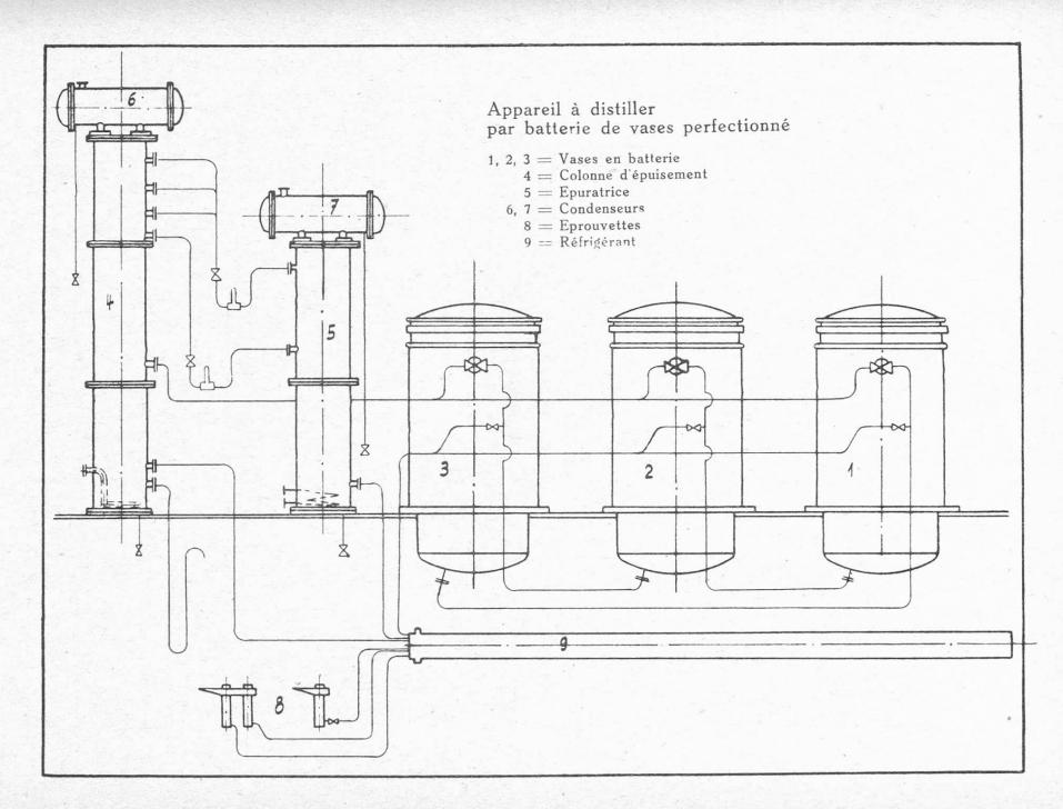
L'appareil est construit de manière qu'on puisse l'utiliser pour la production d'eaux-de-vie qui n'exigent pas la séparation de fortes quantités d'impuretés alcooliques, surtout d'alcool méthylique.
