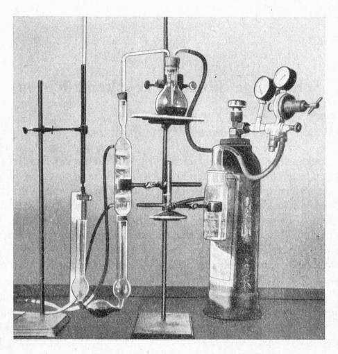
Apparatur zur Bestimmung der gesamten schwefligen Säure
