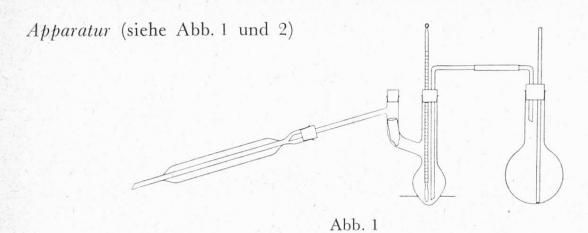
Ein unten spitz ausgezogener Claisenkolben von 50 cm³ Inhalt ist mit einem Dampfentwicklungskolben verbunden, dessen Einleitungsrohr neben einem Thermometer mit Skala bis 150° bis an den Boden des Kolbens reicht. Der Claisenkolben ruht auf einer durchlochten Asbestplatte, deren Ausschnitt 4 cm im Durchmesser hat. Auf der Asbestplatte ist zur bessern Wärmeverteilung ein ausgebuchtetes Drahtnetz angebracht (siehe Abb. 2). Es soll den Boden des Kolbens nicht berühren.
