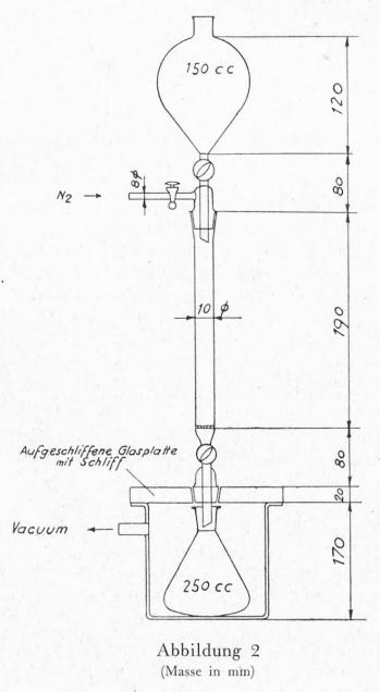
Zur Aktivitätseinstellung des Al<sub>2</sub>O<sub>3</sub>: Chromatogrammrohr, analog dem oberen, jedoch mit ca. 16 mm Durchmesser und ca. 30 cm nutzbarer Länge. Dieses Rohr kann aber auch durch ein einfaches, unten verjüngtes Glasrohr ersetzt werden, bei dem die Verbindungen mittels Gummistopfen hergestellt werden. An Stelle des Glassinterbodens wird ein Wattepfropfen verwendet.
