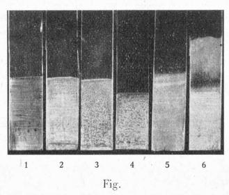
Oxydation catalytique de lamelles d'aluminium sous l'influence de mercure déposé par électrolyse de 50 cm³ de solution
