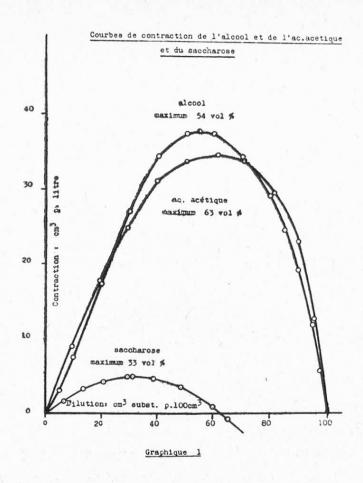
Ces variations pour des substances mélangeables à l'eau en toutes proportions: éthanol et acide acétique suivent un cours assez régulier; la contraction augmente d'abord avec la concentration jusqu'à un certain maximum (54 % d'alcool et 62 % d'acide acétique), puis diminuent progressivement jusqu'à O pour la substance sèche. L'eau et la substance sèche ont une contraction = O. ce qui est conforme avec notre formule:
