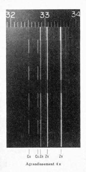
Solution étalon à 1 % de zinc solution inconnue I solution étalon à 0,5 % de zinc solution inconnue I solution étalon à 0,1 % de zinc solution inconnue II solution étalon à 0,5 % de zinc solution étalon à 0,5 % de zinc solution inconnue II solution étalon à 1 % de zinc solution étalon à 1 % de zinc
