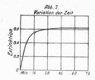
Das Maximum der Extinktion ist nach 45 Minuten erreicht. Aber schon nach 30 Minuten ist man sehr nahe bei diesem Maximum angelangt, so dass ich mich entschloss, bei dieser Zeitdauer zu bleiben.
