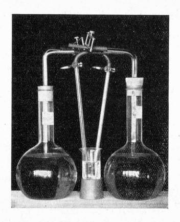
Abbildung 2 Versuchsanordnung bei Kohlensäure-Überlagerung
