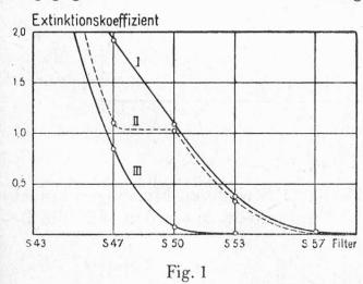
aber ohne Kreatinin wieder. Sie entspricht dem wirklichen Absorptionsspektrum des Kreatininpikrats. Ein Absorptionsmaximum liegt vermutlich zwischen 4700 und 5000 Å. Kurve III zeigt das Absorptionsspektrum der Natriumpikrat - Vergleichslösung, gemessen gegen Wasser. Mit Filter S 47 ist die Absorption der Kreatinin-Reaktionsmischung am grössten. Gleichzeitig absorbiert in diesem Gebiet auch die Pikratlösung ziemlich stark. Da nun in jeder Kreatinin-Reaktions-
