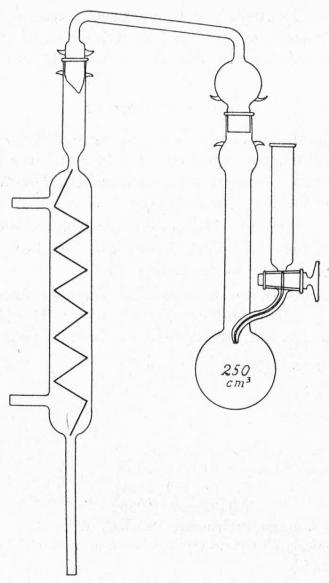
Fig. G Appareil d'oxydation et distillation pour dosage de l'acide citrique
