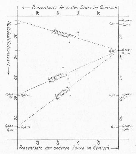
Abb. 1 Nomogramm zur Berechnung der Mengenverhältnisse der niederen Fettsäuren in Zweisäuregemischen
