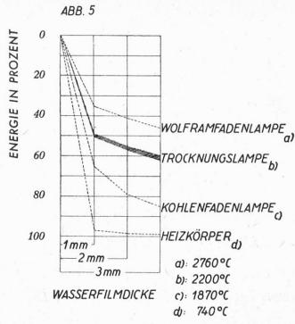
Eindringungsfähigkeit von Infrarot verschiedener Strahlungsquellen in Wasser
