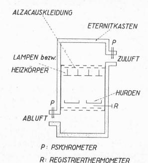
Versuchskasten für Vergleiche zwischen Heissluftumwälzung und Infrarotstrahlung
