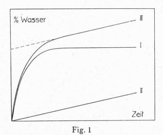
Trocknen wir einen wasserhaltigen, nicht zersetzbaren Stoff, etwa ein Salz wie BaCl<sub>2</sub>+2H<sub>2</sub>O, und tragen wir die nach bestimmten Zeiten gefundenen Werte auf, so finden wir die Kurve I. Nachdem das Wasser entwichen ist, verläuft die Kurve genau horizontal.
