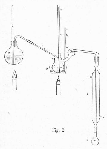
Le ballon A, d'un litre environ de contenance, sert de générateur de vapeur d'eau. A est relié au cours de l'opération à C par un tube en caoutchouc.
