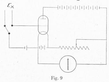
Fig. 9 zeigt schematisch die Schaltung eines einfachen Röhrenpotentiometers, wie sie vor längerer Zeit von Berl, Herbert und Wahlig angegeben worden ist. Jeder Radiobastler wird in der Lage sein, ein solches Instrument mit wenig Mitteln zusammenzustellen.
