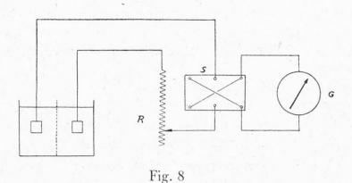
G ist ein Galvanometer oder Millivoltmeter mit hohem innern Widerstand; S ist ein Stromwender und R ein Regulierwiderstand.
