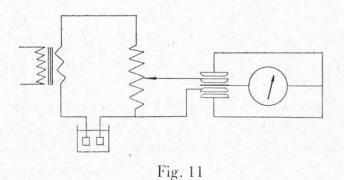
Recht gut brauchbar ist die in Fig. 11 wiedergegebene Messvorrichtung. Sie besteht aus
