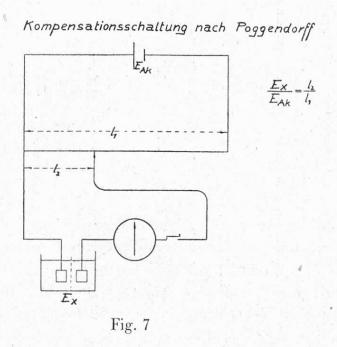
Weit verbreitet ist die Potentialmessung nach der Poggendorff'schen Kompensationsmethode (Fig. 7). Man braucht dazu eine Stromquelle (Akkumulator), eine Messbrücke, ein Nullinstrument und einen Taster. Man kompensiert durch Verschieben des Schleifkontaktes so lange, bis im Sekundärkreis Stromlosigkeit festgestellt wird; dann besteht die Beziehung
