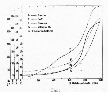
Kurven der durchgemahlenen Mehle einer Weizenmühle. Passagenmehle geordnet nach steigendem Aschegehalt.
