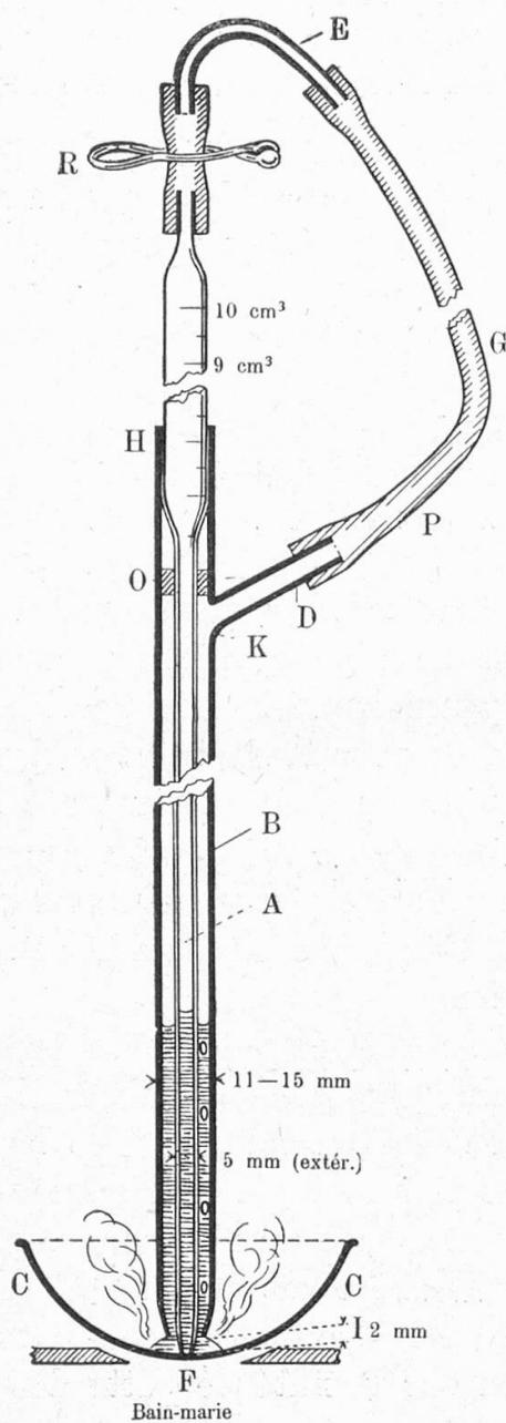
Le tube A est mobile par rapport à B, avec une résistance au déplacement cependant suffisante. On peut ainsi régler exactement l'intervalle I. La distance de F à K doit être choisie de manière que le volume de liquide pouvant être contenu par les deux tubes A et B dans l'intervalle en question soit de  $10 \text{ cm}^3$ .
