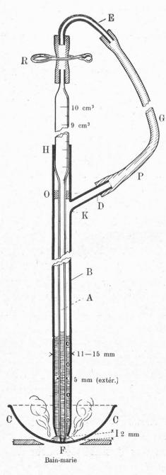
Le tube A est mobile par rapport à B, avec une résistance au déplacement cependant suffisante. On peut ainsi régler exactement l'intervalle I. La distance de F à K doit être choisie de manière que le volume de liquide pouvant être contenu par les deux tubes A et B dans l'intervalle en question soit de 10 cm<sup>3</sup>.
