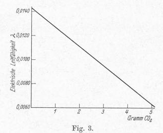
stone'schen Brücke gemessen<sup>3</sup>). Bei 500 cm<sup>3</sup>  $\frac{n}{2}$ -KOH erfolgt diese Aenderung bis zur Absorption von ca. 4,8 g Kohlensäure linear (Fig. 3) und folgt der Gleichung  $\lambda = \lambda_0 - k$ . g CO<sub>2</sub>,
