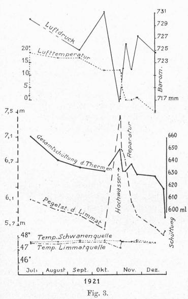
Wirkung eines Hochwassers auf Schüttung und Temperatur der Badener Thermengruppe. Der Einfluss ist deutlich feststellbar, aber gering.
