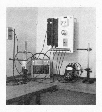
Zur quantitativen elektrolytischen Bestimmung des in lebensmittelchemischen Laboratorien im Vordergrund stehenden Kupfers sind eine Reihe von Bedingungen einzuhalten, wovon die wichtigsten die Stromdichte, die Temperatur, die Acidität und die Elektrolysendauer sind.
