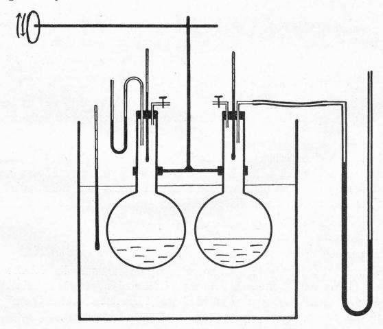
von 100 cm³ Inhalt gegeben, welches mit einem dreifach durchbohrten Gummistopfen verschlossen wird. Durch das eine Loch ist das Kölbchen mit einem Wassermanometer in Verbindung. Im zweiten Loch steckt ein Thermometer, das jedoch nicht in die Flüssigkeit eintaucht, und durch das dritte Loch führt ein Glasrohr mit Hahn. Das Kölbchen wird an einer Schüttelmaschine so befestigt, dass es in einem Thermostaten schwingen kann.
