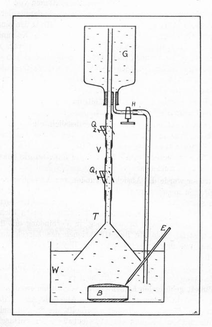
von  $Q_1$ ,  $Q_2$  und H quantitativ in das Gasometer unter Verdrängung von Kochsalzlösung, die durch den Schlauch in die Wanne zurückfliesst.
