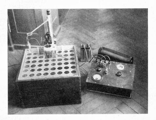
Als Leitfähigkeitsgefäss dient eine aus einem Glaszylinder und den von oben eingeschmolzenen Platinelektroden bestehende Taucheletrode, die in die in den Bechergläschen befindliche Flüssigkeit eingetaucht wird.
