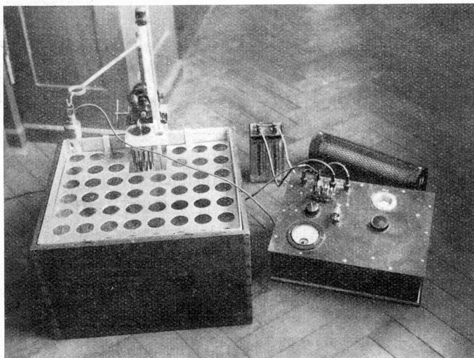
Als *Leitfähigkeitsgefäß* dient eine aus einem Glaszyylinder und den von oben eingeschmolzenen Platinelektroden bestehende Taucheletrode, die in die in den Bechergläschen befindliche Flüssigkeit eingetaucht wird.
