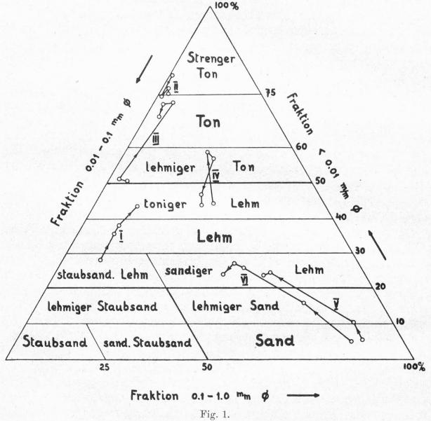
Bodenartenklassifikation auf Grund der mechanischen Bodenanalyse (Diagramm nach dem Vorschlag der Kulturingenieure des Kantons Zürich).
