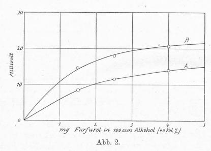
trierte Salzsäure zugegeben und mit einem feinen Glasstäbchen durchgemischt. Bald trat die Rosafärbung auf. Nach 15 Minuten Stehen wurde jeweils die Messung ausgeführt und die in Abbildung 2 dargestellte Eichkurve A erhalten. Die in der Abbildung durch Kreise markierten Werte sind Kontrollpunkte. Sie lassen die Fehlergrenze erkennen.
