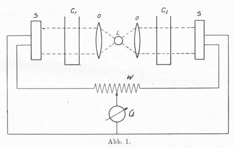
In Anlehnung an die Apparatur von  $B.\ Lange$  wurde auf unsere Veranlassung von Ingenieur  $E.\ Schiltknecht^3)$  das in Abbildung 1 schematisch dargestellte Instrument konstruiert, das anstelle der von Lange verwendeten Kupfer-Cuprooxydzellen mit Selenzellen arbeitet.
