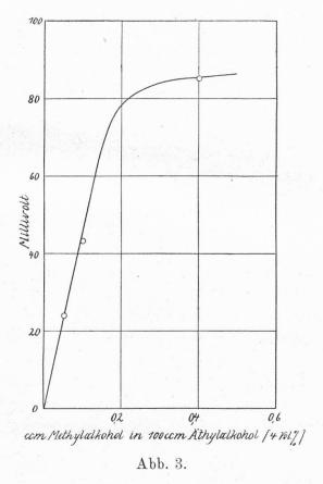
$20~\rm cm^3$  der Lösung in Küvette  $C_1$  abpipettiert und die Messung in der beschriebenen Weise vorgenommen. Die Eichkurve ist in Abbildung 3 wiedergegeben. Die Kreise zeigen Kontrollwerte an.
