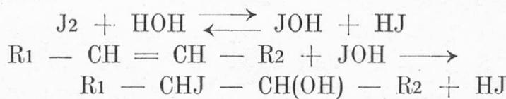
Die Bestimmung der Jodzahl nach dieser Methode besteht darin, dass die zu untersuchende Substanz in Alkohol gelöst, wenn nötig unter
