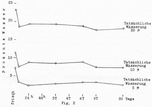
Nach Formel a berechneter Wasserzusatz bei Serie 3. Die Abscisse ist nach rechts stark verkürzt.
