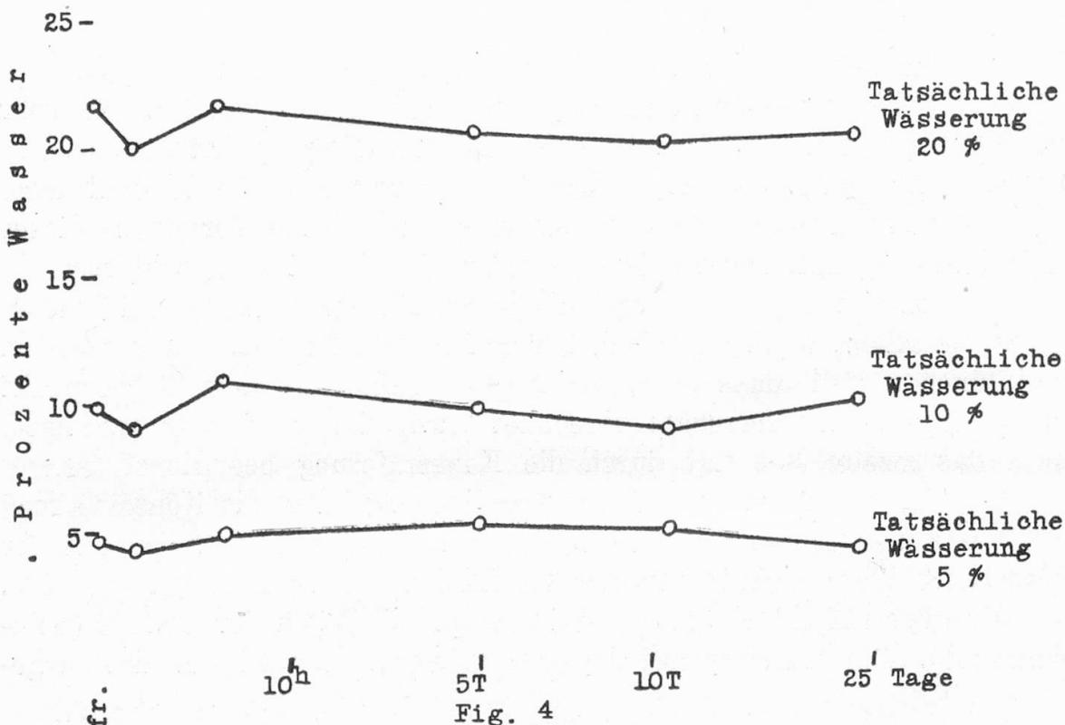
Nach Formel a berechneter Wasserzusatz bei Serie 4.
