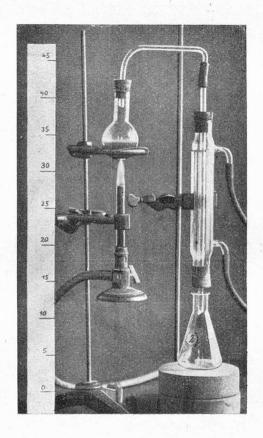
Man destilliert unter Verwendung eines kleinen senkrechten Liebig'schen Kühlers, dessen Kühlerrohr 30 cm lang und 5 mm weit ist (vergl. obenstehende Abbildung), mit ziemlich kleiner Flamme unter zeitweiligem Umschwenken in einen 100 cm³-Erlenmeyerkolben, bis 20 cm³ übergegangen sind.
