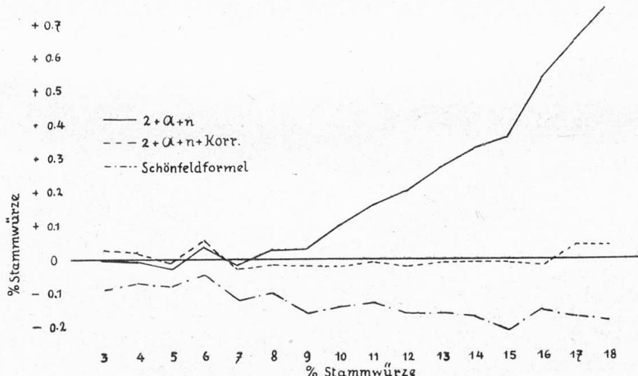
Von den zur Analyse gelangenden Bieren wurde die ursprüngliche Stammwürze nach der alten Ballingformel berechnet im Durchschnitt
