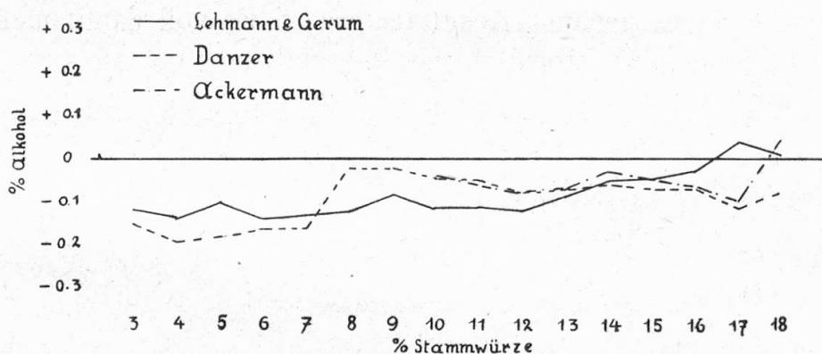
grösserem Masse bei der Berechnung der Stammwürze aus. Um die Differenzen feststellen zu können, die sich bei der Berechnung der Stammwürze aus den verschiedenen Berechnungsarten wie Ackermann, Danzer, Lehmann und Gerum ergeben, wurde dieselbe nach der Doemensformel  $2 \cdot A + n + \text{Korrektur}$  errechnet. Ebenso wurde bei der Berechnung nach Lehmann und Gerum die alte Stammwürzeberechnungsformel  $2 \cdot A + n$
